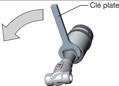
Fig. 5 : Tourner avec une clé plate
