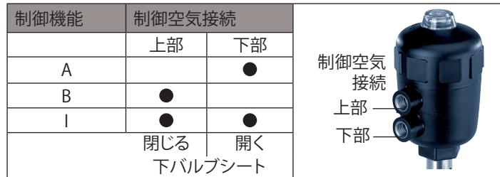
挿図 6: 制御空気接続
