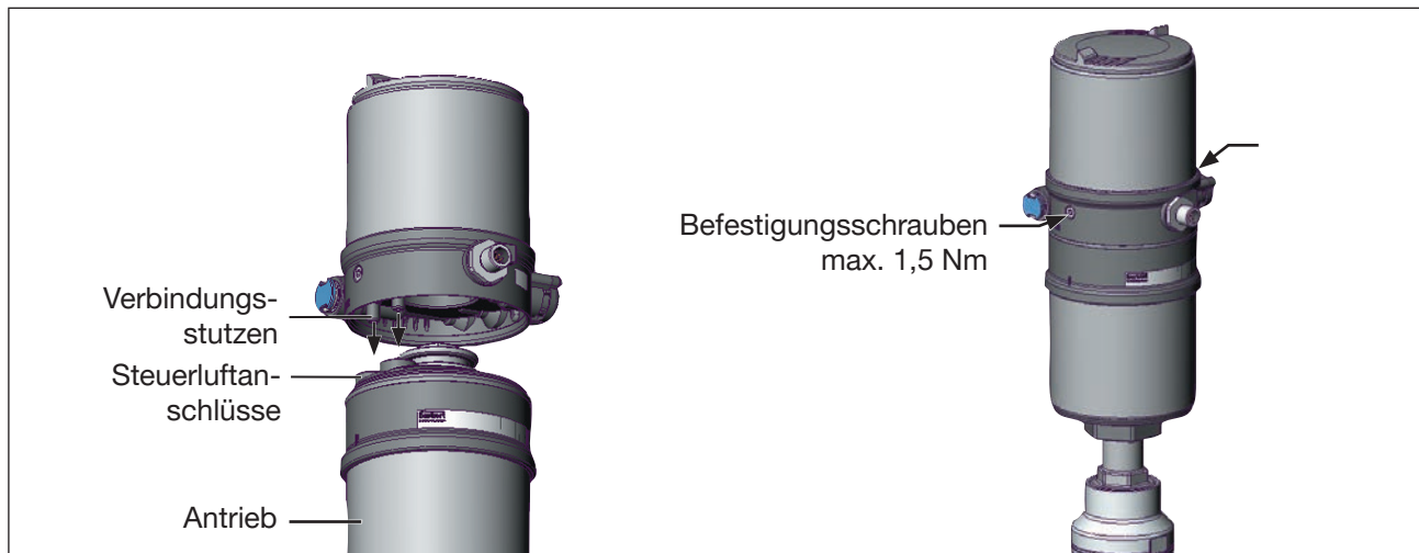
Bild 22: Montage Positioner, Reihe 2103, 2300 und 2301
