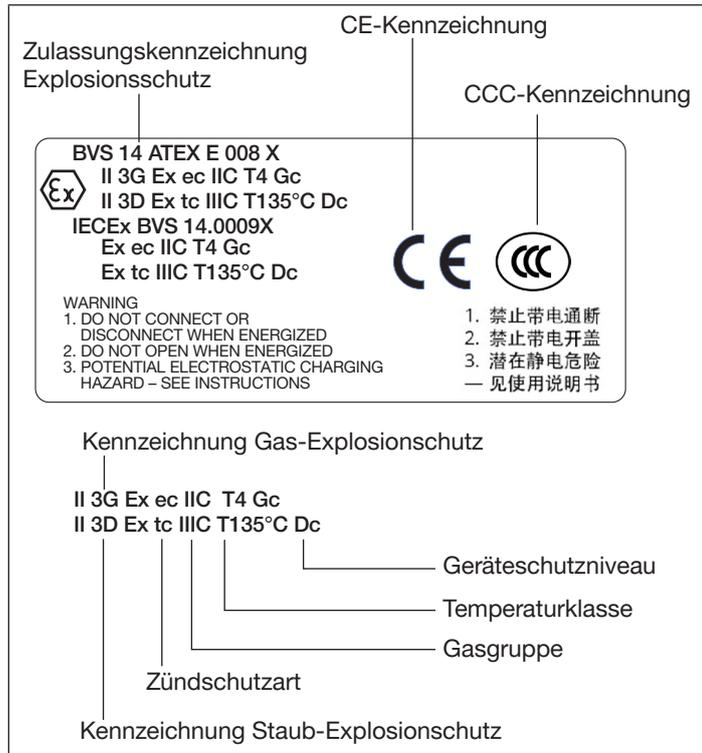
Bild 3: Beispiel Klebeschild für Zulassung, Variante PX03
