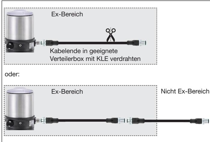
Bild 11: Installation Kabeltyp 2...4
