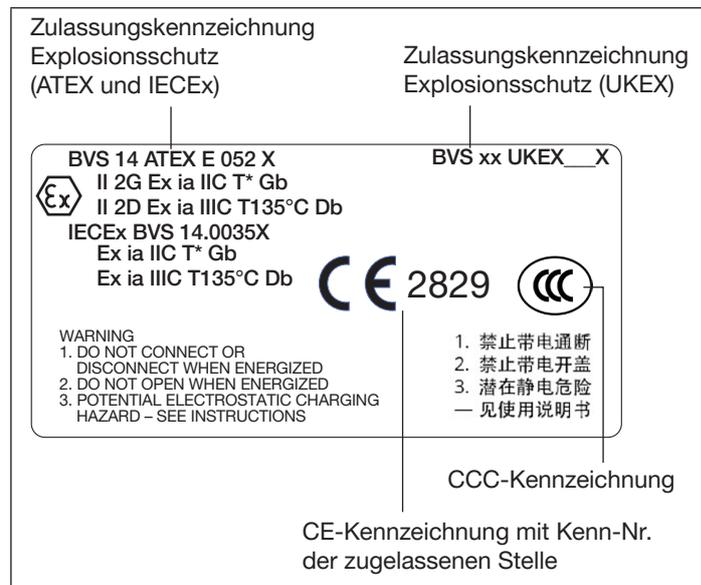
Bild 2: Beispiel Klebeschild für Zulassung, Variante PX16
