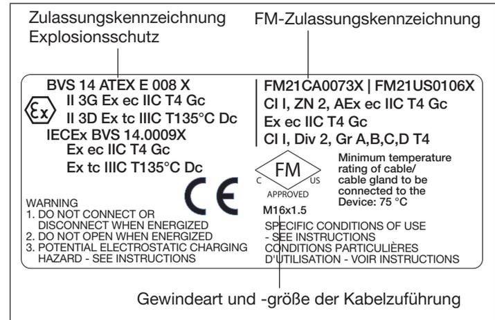
Bild 4: Beispiel Klebeschild für Zulassung, Variante PR07
