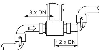
Das komplette Messgerät kann sowohl in waagerechte als auch in senkrechte Rohre eingebaut werden, wobei jedoch die folgenden zusätzlichen Bedingungen zu beachten sind:
