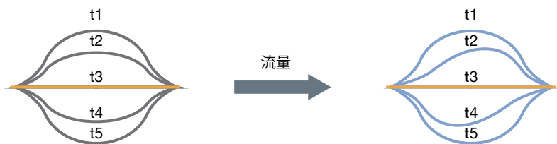
媒体がない状態でのパイプの振動
