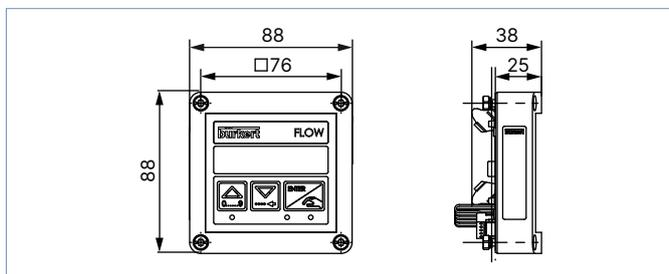
**Durchflusstransmitter für „Low Power“-Durchflussmesser, Wandmontage-Variante**
