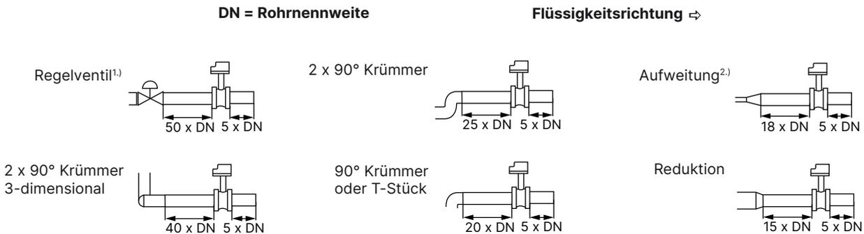
1.) Falls das Regelventil nicht nach dem Messgerät angeordnet werden kann, müssen diese minimalen Beruhigungsstrecken eingehalten werden.
