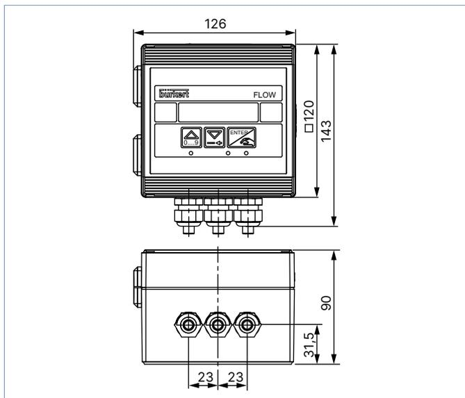
**Durchflusstransmitter für „Low Power“-Durchflussmesser, Schaltschrankmontage-Variante**
