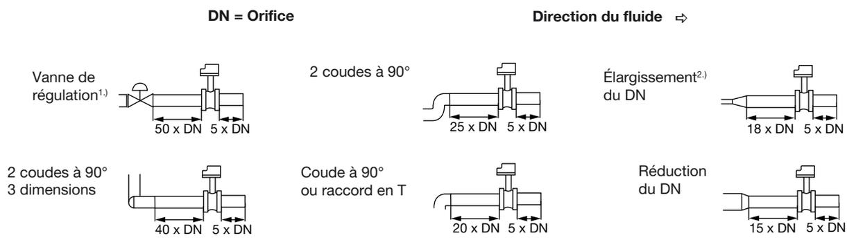
1.) Si la vanne ne peut pas être placée après l'appareil de mesure, les distances minimales doivent être respectées.
