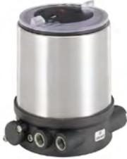
Der kompakte Stellungsregler Typ 8694/8696 ist für den integrierten Anbau an pneumatische Antriebe der Prozessregelventilreihen Typ 23xx/2103 und speziell für die Anforderungen hygienischer Prozessbedingungen konzipiert. Die Bedienung und Parametrierung werden über Taster und DIP-Schalter vorgenommen. Die Gerätekonfiguration und -parametrierung kann auch bequem über eine PC-Schnittstelle mit Hilfe der Bürkert-Software vorgenommen werden.
