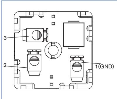
L'électronique à inversion de type 2508 IN permet de commander les vannes à impulsions avec une commande à inversion de polarité par l'utilisation de 3 signaux de pilotage (ON, OFF et GND). La commutation s'effectue par inversion de la tension d'alimentation de la vanne.
