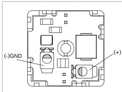
Die Elektronik Typ 2508 LR dient zur Leistungsreduzierung von Magnetventilen. Damit lassen sich Leistungsverbrauch und Spulentemperatur z. B. bei Dauerbetrieb erheblich reduzieren. Die Anzugsleistung entspricht hierbei die Nennleistung der Magnetspule. Nach dem Schalten des Magnetventils senkt die Elektronik auf eine geringe Halteleistung ab. Im Haltebetrieb wird die Funktion durch eine gelbe Leuchtdiode angezeigt.
