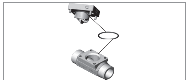
Fig. 5 : Emplacement du joint sur un raccord S030 HT
